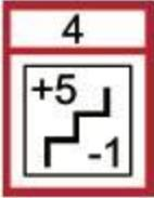
Treppenraum; mit brandschutztechnisch bemessener baulicher Abtrennung, erreichbare Geschosse, mit Treppenraumbezeichnung (Beispiel: Treppenraum 4)
