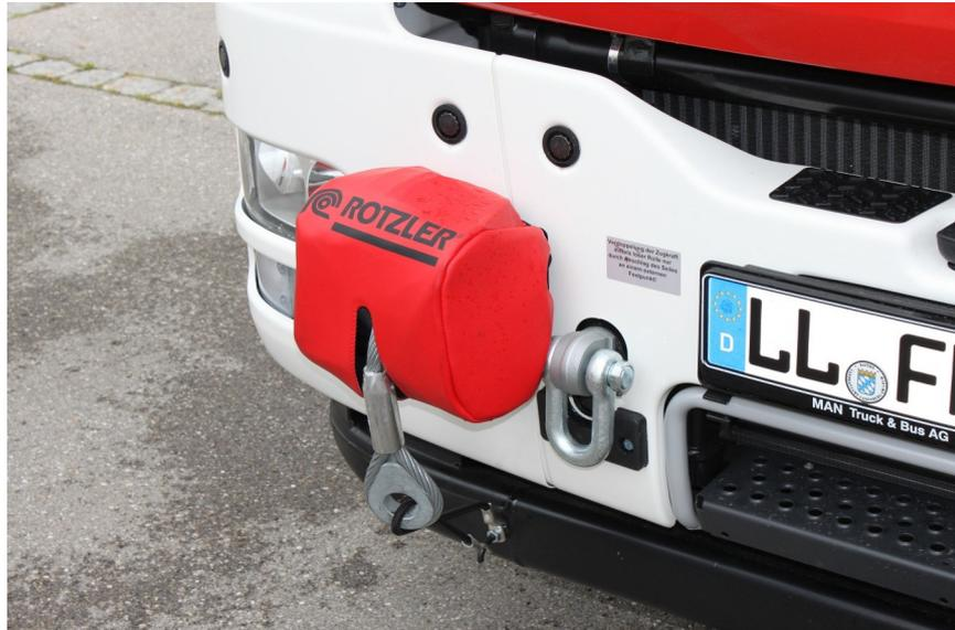
Winde: 8t Zugkraft einfach, 16 t Zugkraft mit loser Rolle
